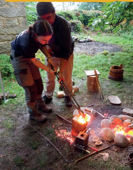
Fabrication d'un objet en bronze par moulage au sable
